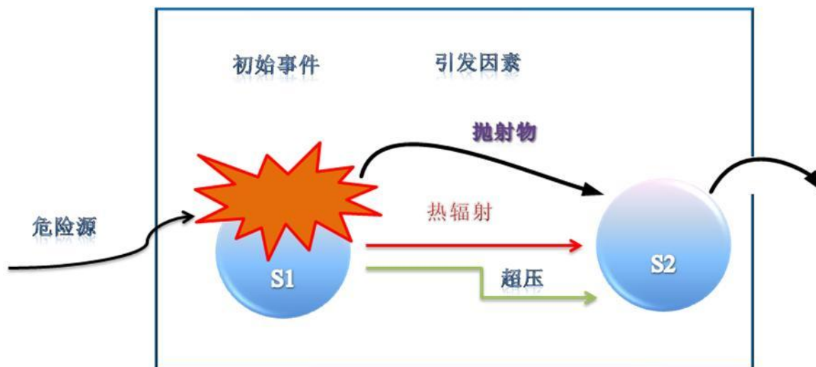
图 4.4.3-1 多米诺效应系统图
